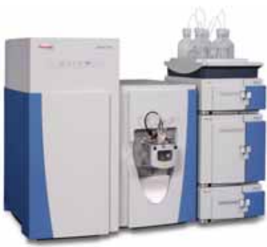
Жидкостной хроматограф в сочетании с масс-спектрометром с орбитальной ионной ловушкой (настольный вариант, производитель THERMO)
