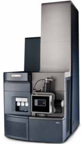
Времяпролетный масс-спектрометр, который может сочетаться как с жидкостным, так и с газовым хроматографом (производитель WATERS)
